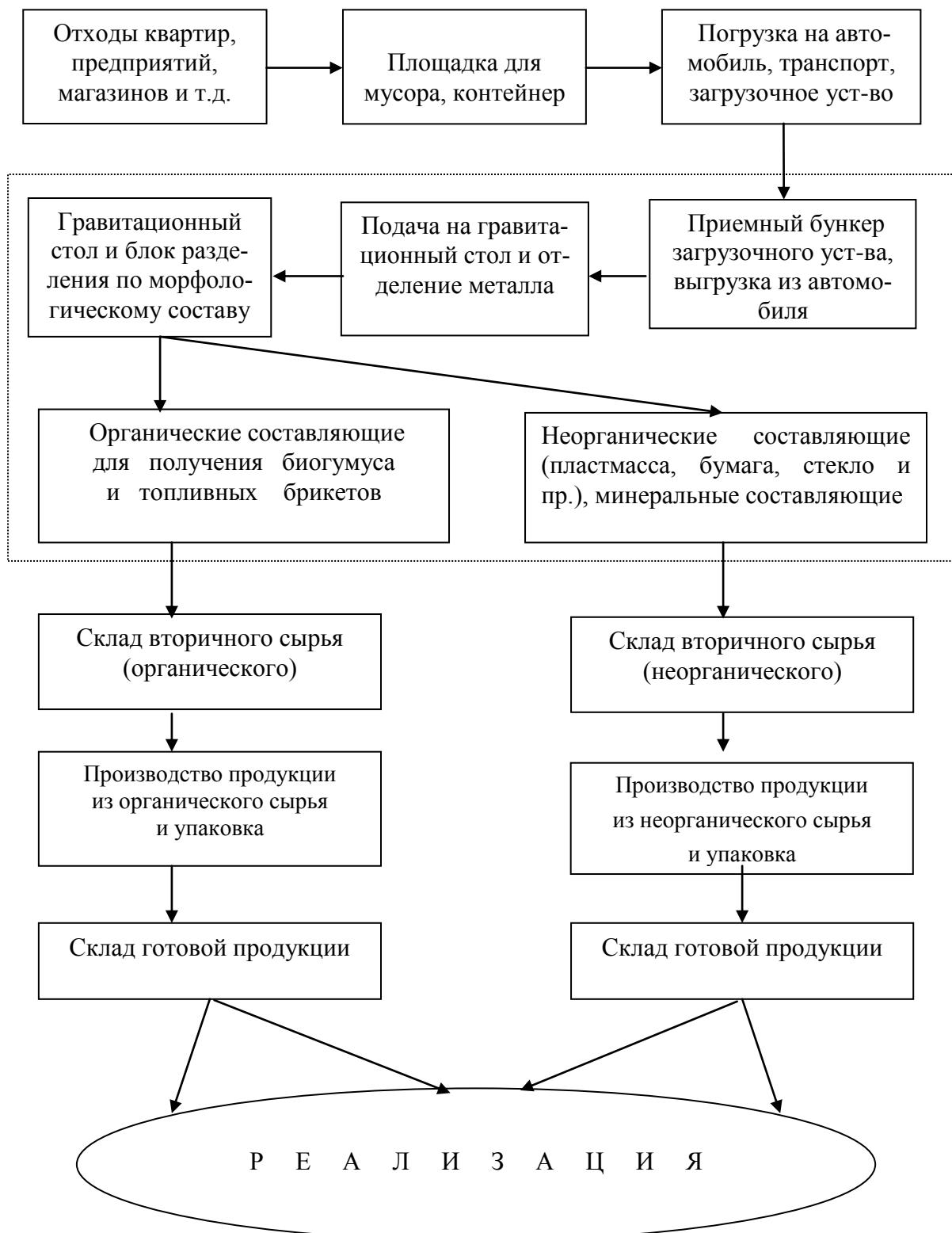
Рис. 1. Структурная схема функционирования мусороперерабатывающего завода
