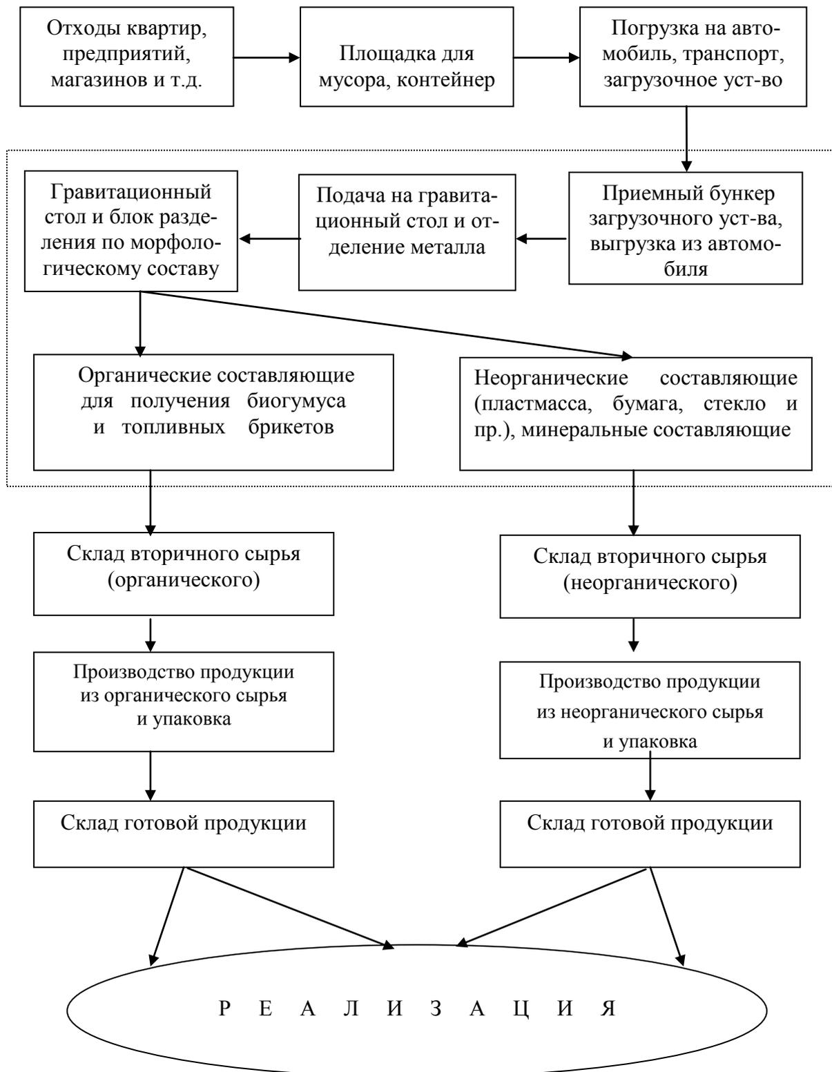
Рис. 1. Структурная схема функционирования мусороперерабатывающего завода
